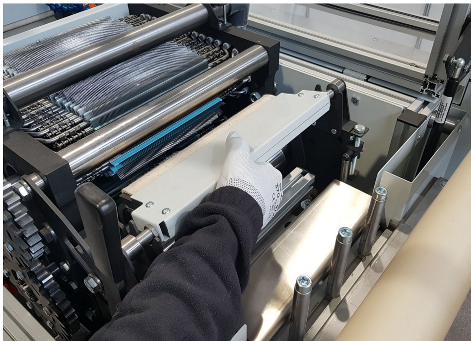
Figura 5.5.2 – Rimozione della barra pulitrice
