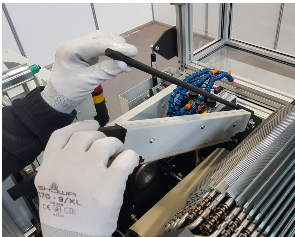
Figura 5.5.7 – Sollevamento della barra pulitrice e dell'asta di sostegno
