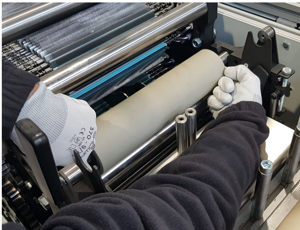
Figura 5.5.4 – Rimozione del cilindro di pressione
