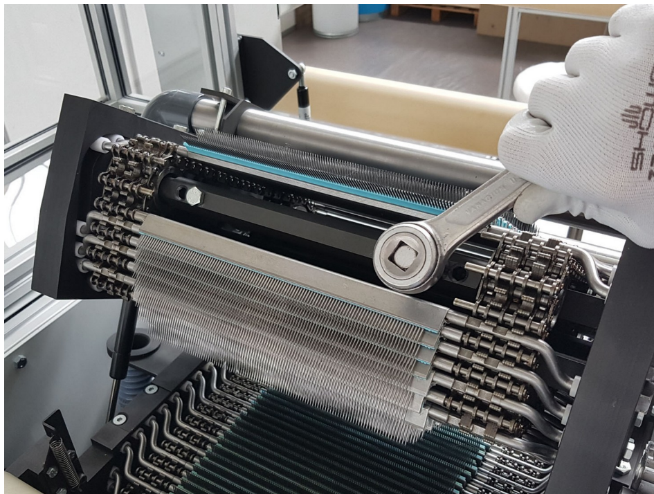
Figura 6.3.7 – Allentamento delle viti di bloccaggio
