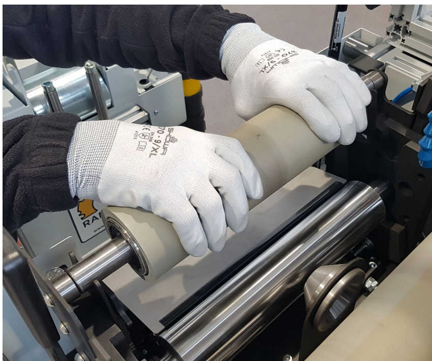
Figura 5.5.12 – Posizionamento del cilindro di pressione
