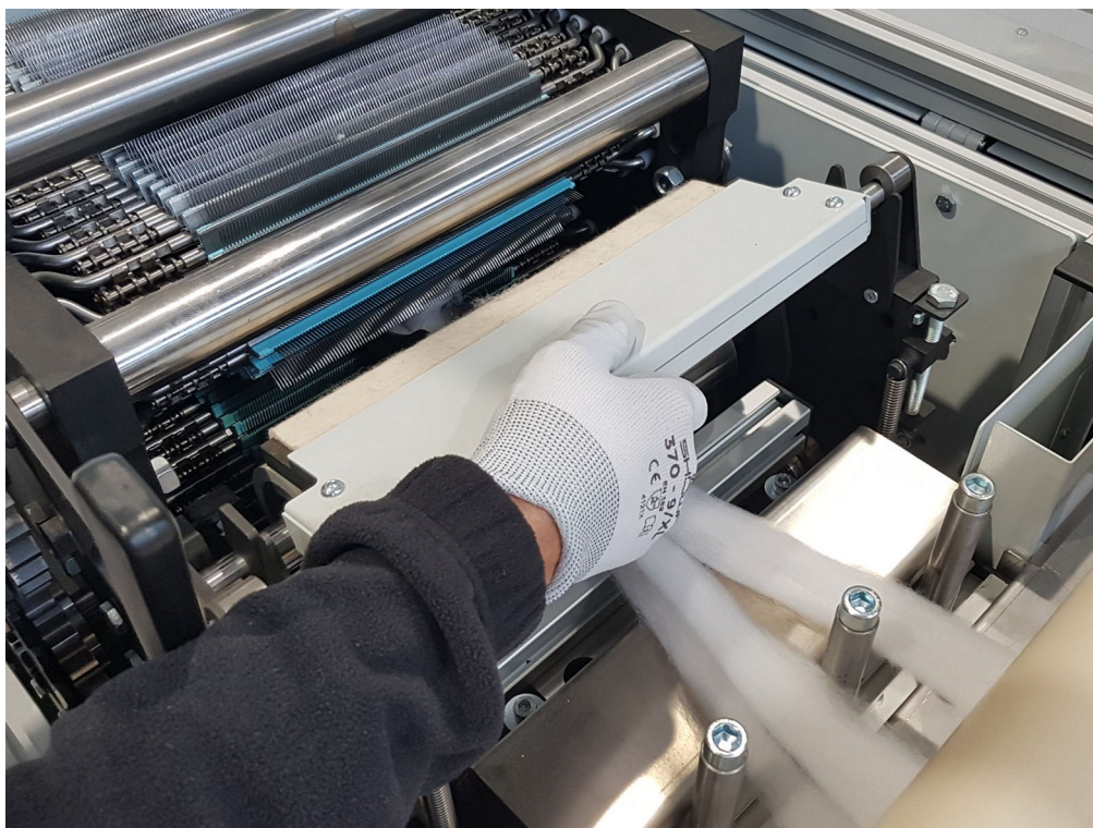
Figura 5.5.24 – Posizionare la barra pulitrice
