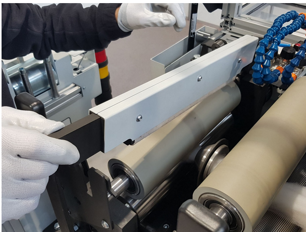
Figura 5.5.18 – Abbassare la barra pulitrice
