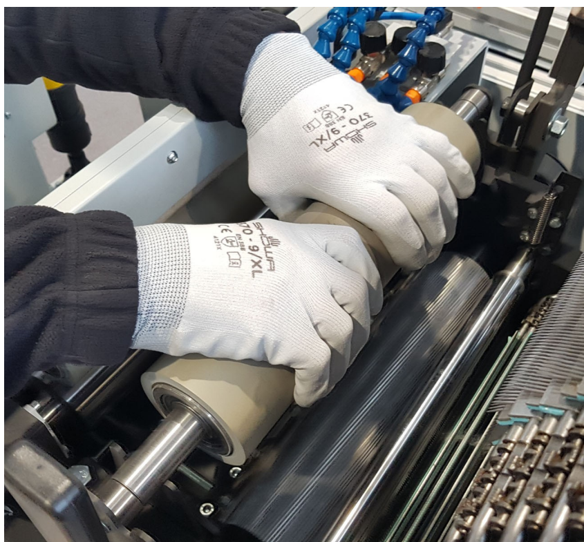
Figura 5.5.9 – Posizionamento del cilindro di pressione
