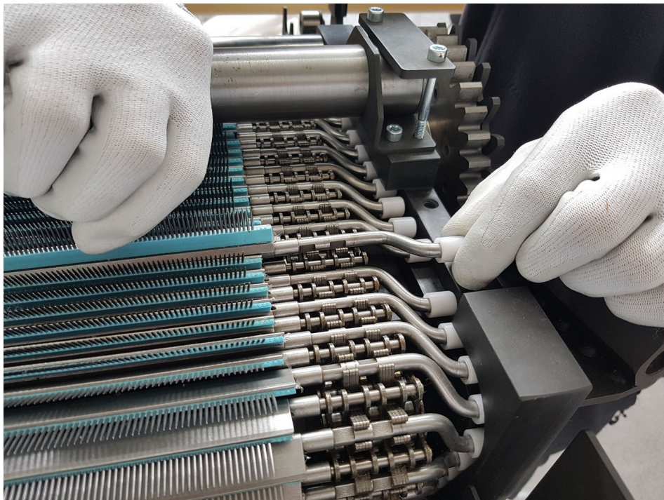
Figura 6.3.4 – Rimozione del pettine
