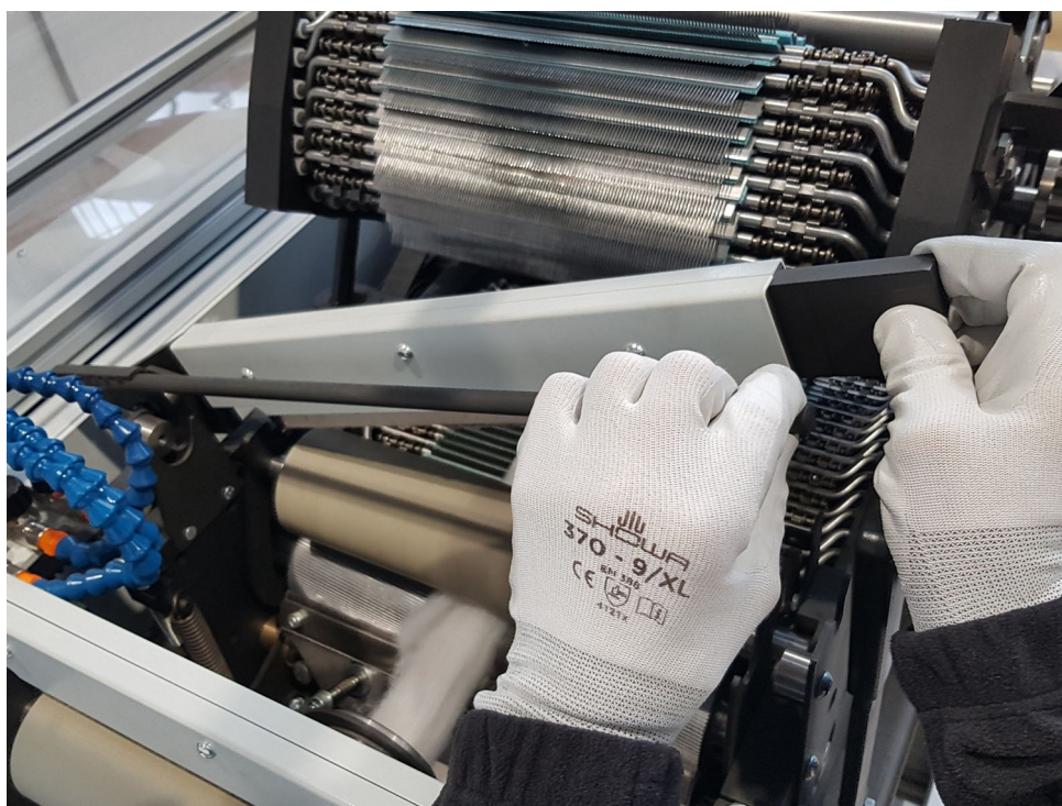
Figura 5.5.20 – Abbassare la barra pulitrice e l'asta di sostegno
