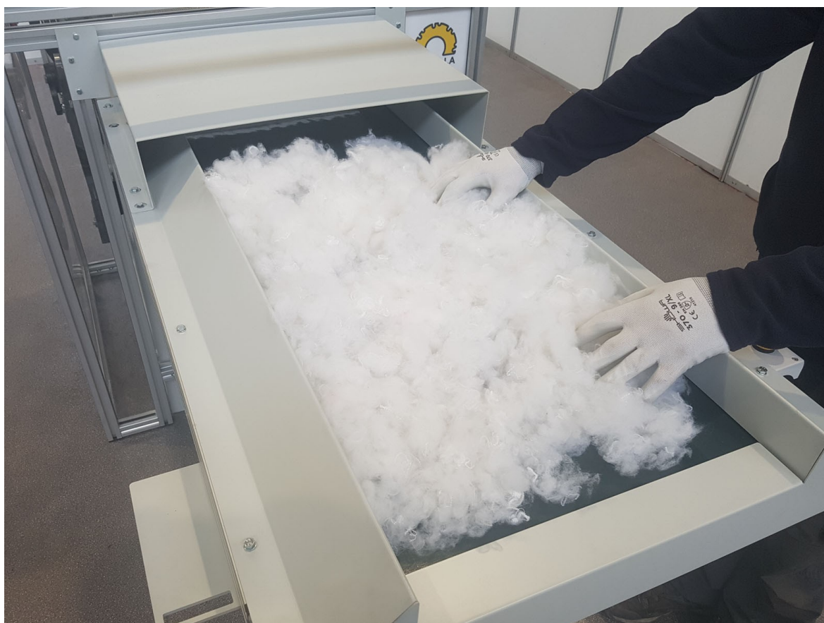
Figura 5.5.2 – Posizionamento delle fibre sul nastro trasportatore di ingresso
