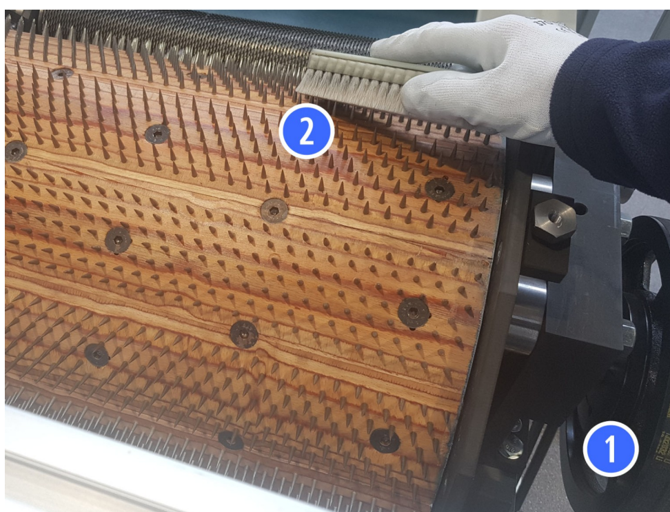
Figura 6.2.5 – Pulizia del cilindro principale
