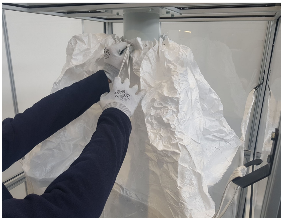
Figura 5.5.1 – Fissaggio del sacco di raccolta delle fibre
