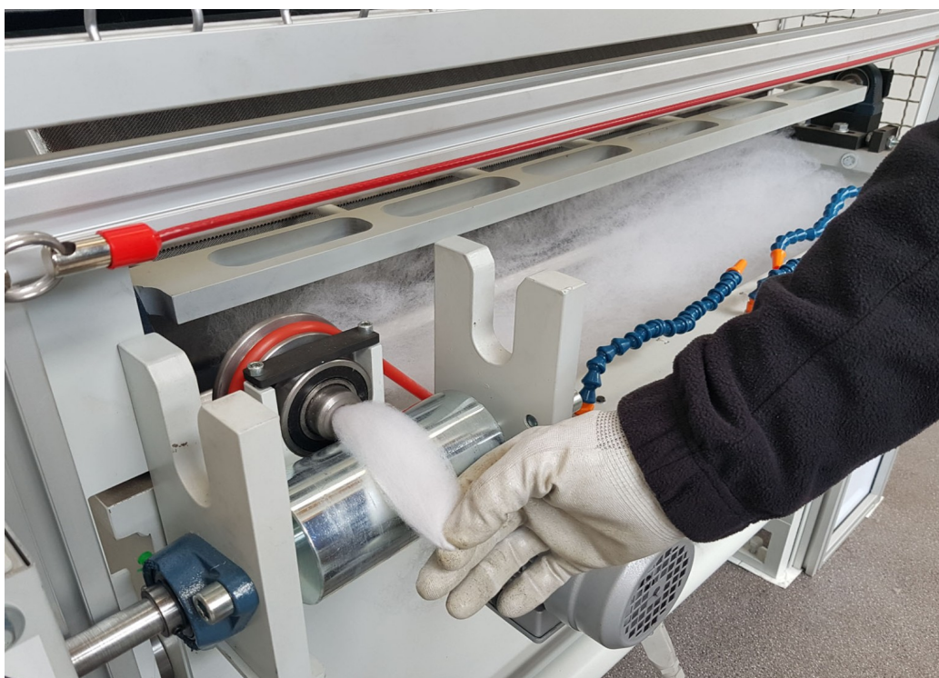
Figura 5.6.11 – Passaggio delle fibre attraverso la girante
