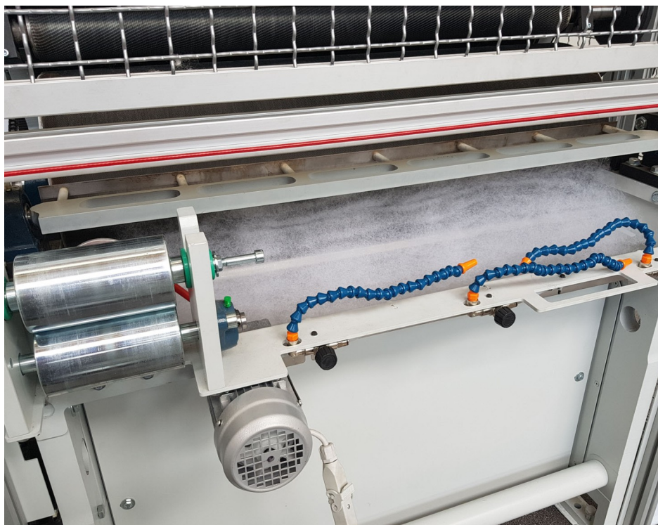
Figura 5.6.10 – Verifica della consistenza del velo di fibre
