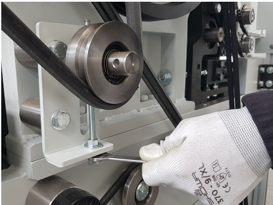
Figura 6.4.12 – Tensionamento della cinghia di comando rulli volteggianti
