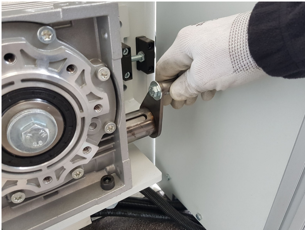
Figura 6.2.5 – Rotazione manuale del cilindro pettinatore e dei rulli lavoratori
