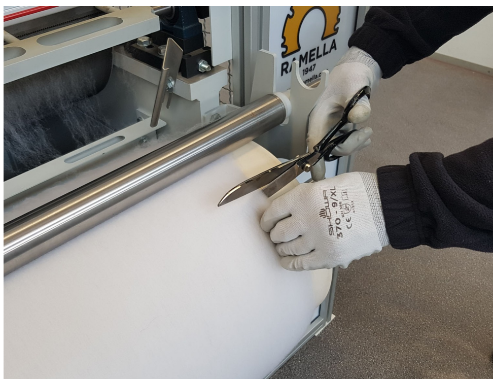
Figura 5.6.6 – Taglio dello strato di fibre avvolte
