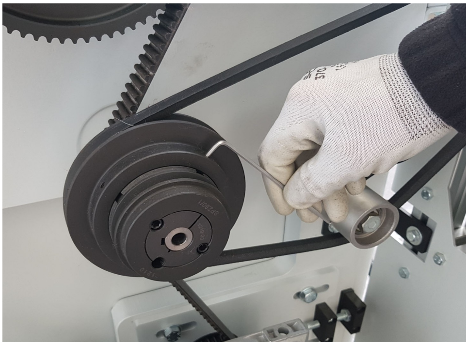
Figura 6.1.1 – Rimozione dei grani di bloccaggio
