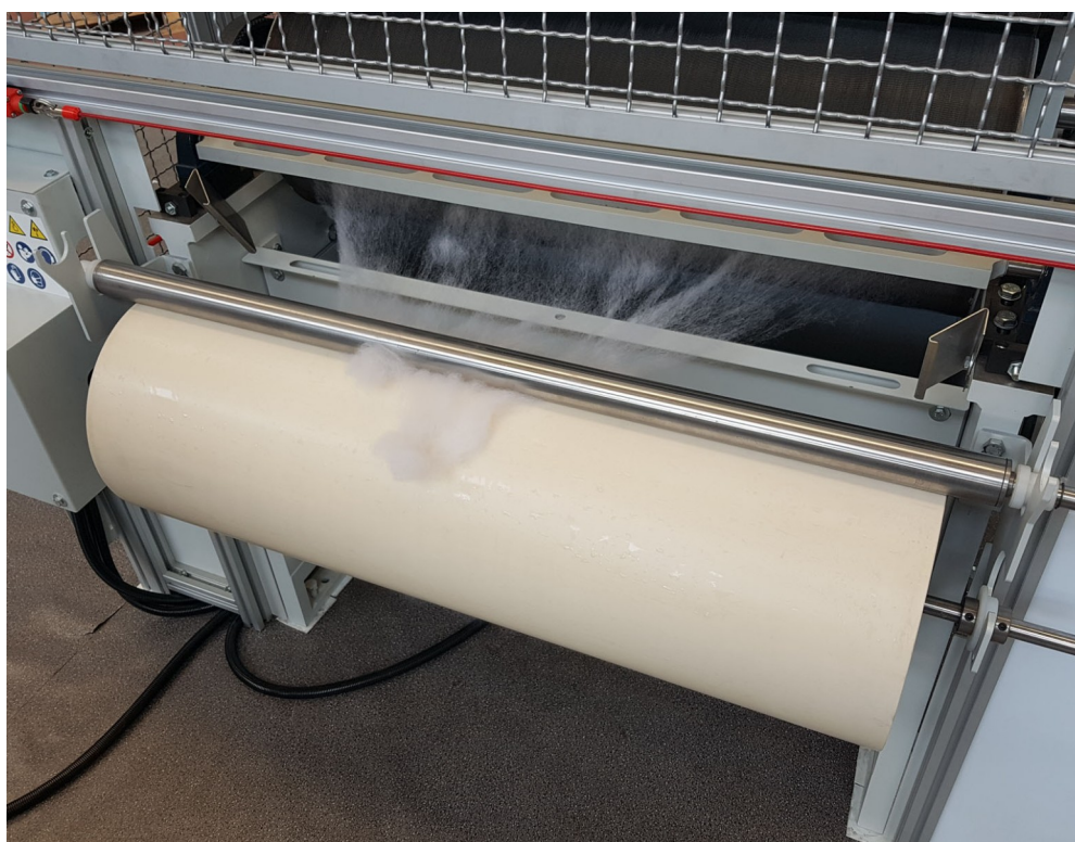
Figura 5.6.4 – Adesione del velo di fibre e posizionamento del cilindro di pressione
