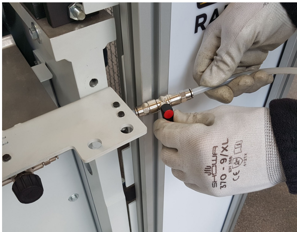
Figura 5.6.9 – Chiusura del rubinetto dell'aria compressa
