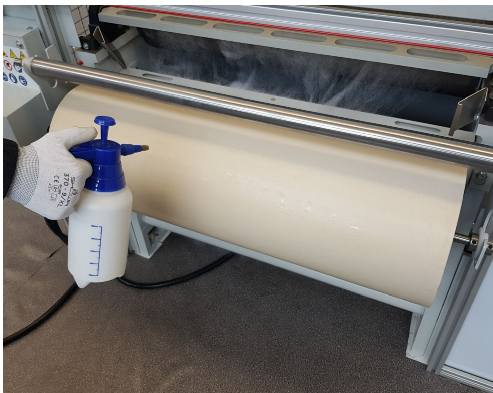
Figura 5.6.3 – Superficie del cilindro avvolgitore inumidita
