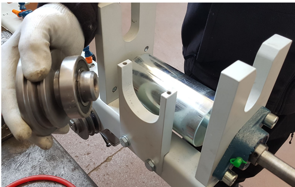
Figura 6.1.5 – Sostituzione della girante
