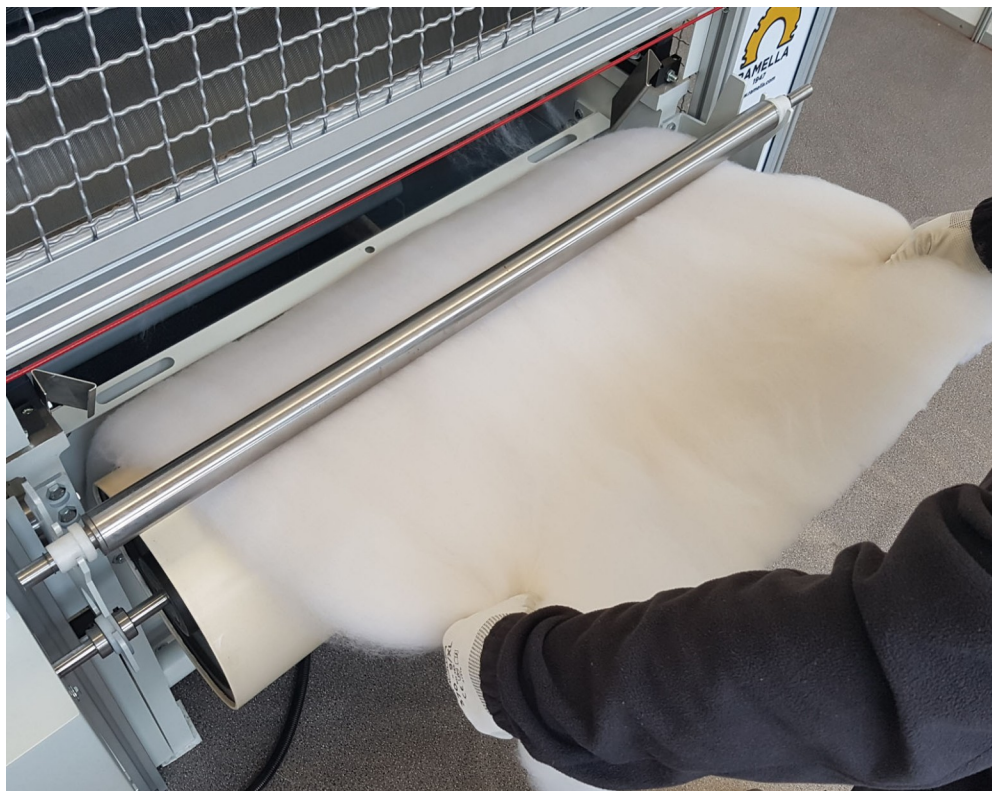
Figura 5.6.7 – Rimozione dello strato di fibre avvolte
