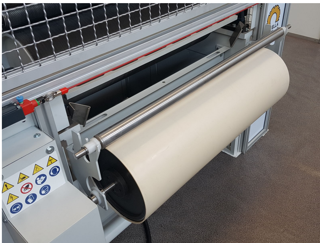
Figura 5.5.10 – Posizionamento del rullo di pressione
