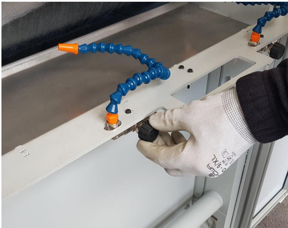
Figura 6.1.2 – Regolazione del flusso d'aria
