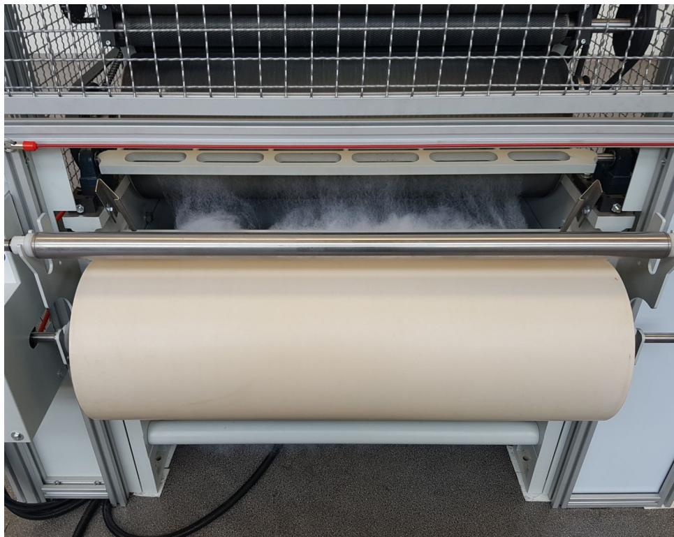
Figura 5.6.2 – Verifica della consistenza del velo di fibre
