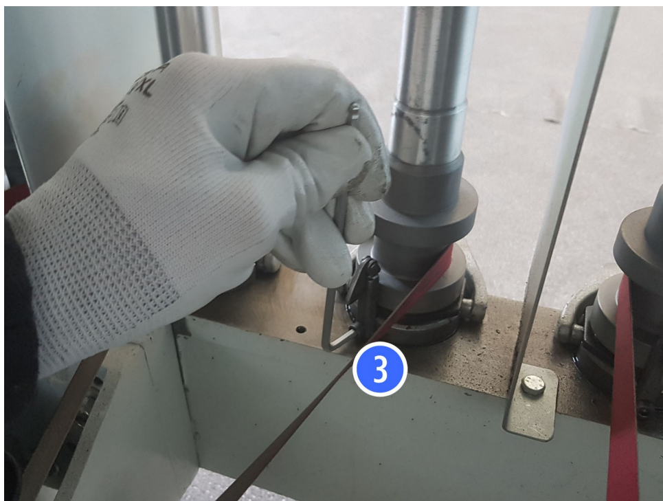
Figura 4.4.6 – Rimozione del dispositivo di fermo per il fuso
