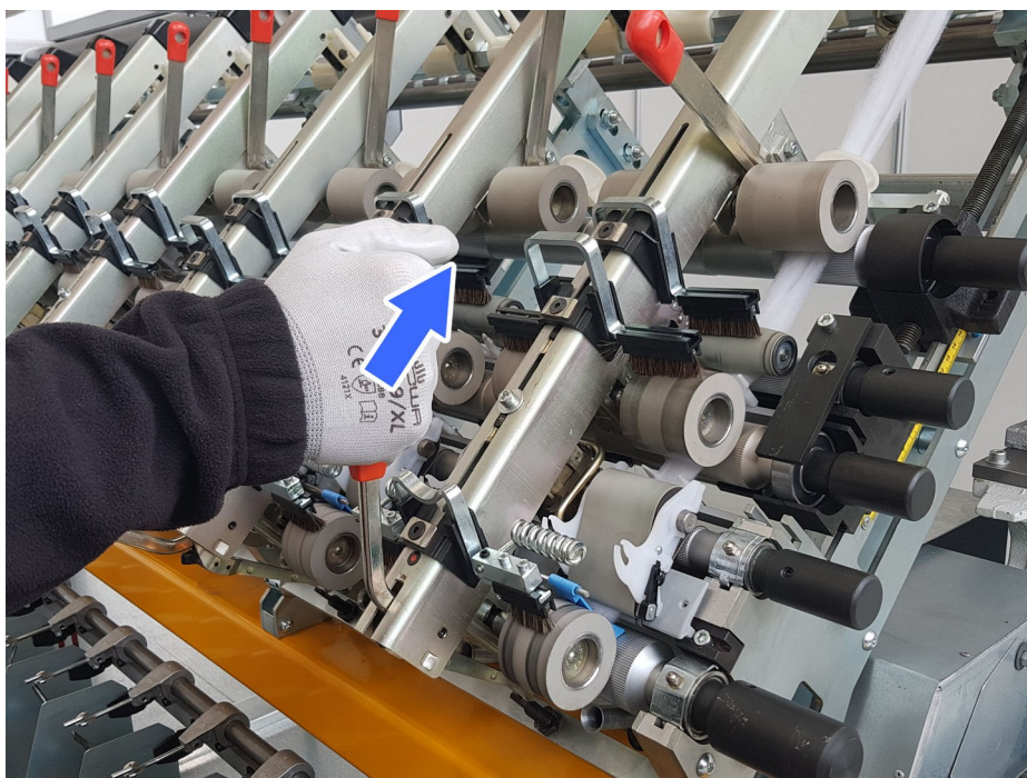
Figura 5.5.6 – Attivazione e bloccaggio del braccio di stiro
