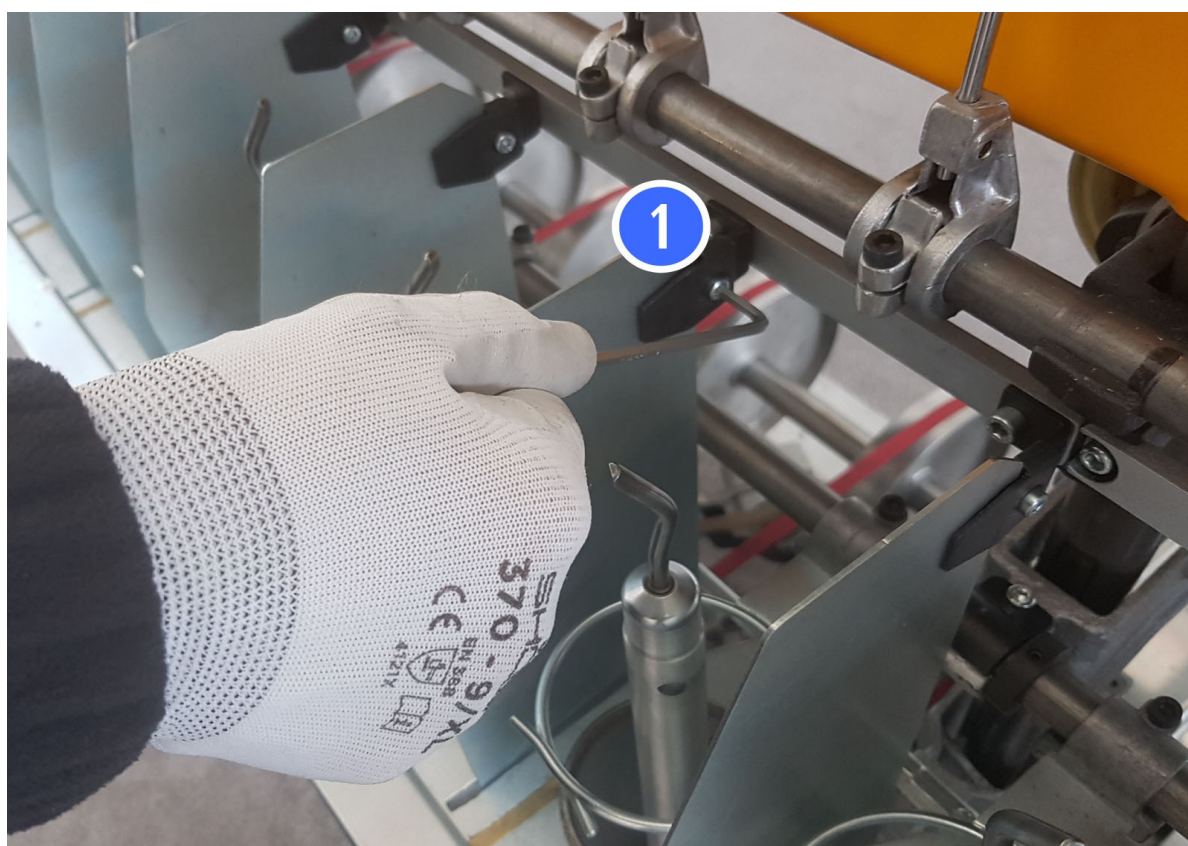
Figura 4.4.4 – Rimozione delle lamiera divisoria
