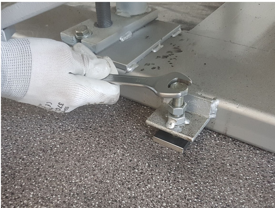
Figura 4.4.9 – Regolazione della distanza dal suolo del basamento
