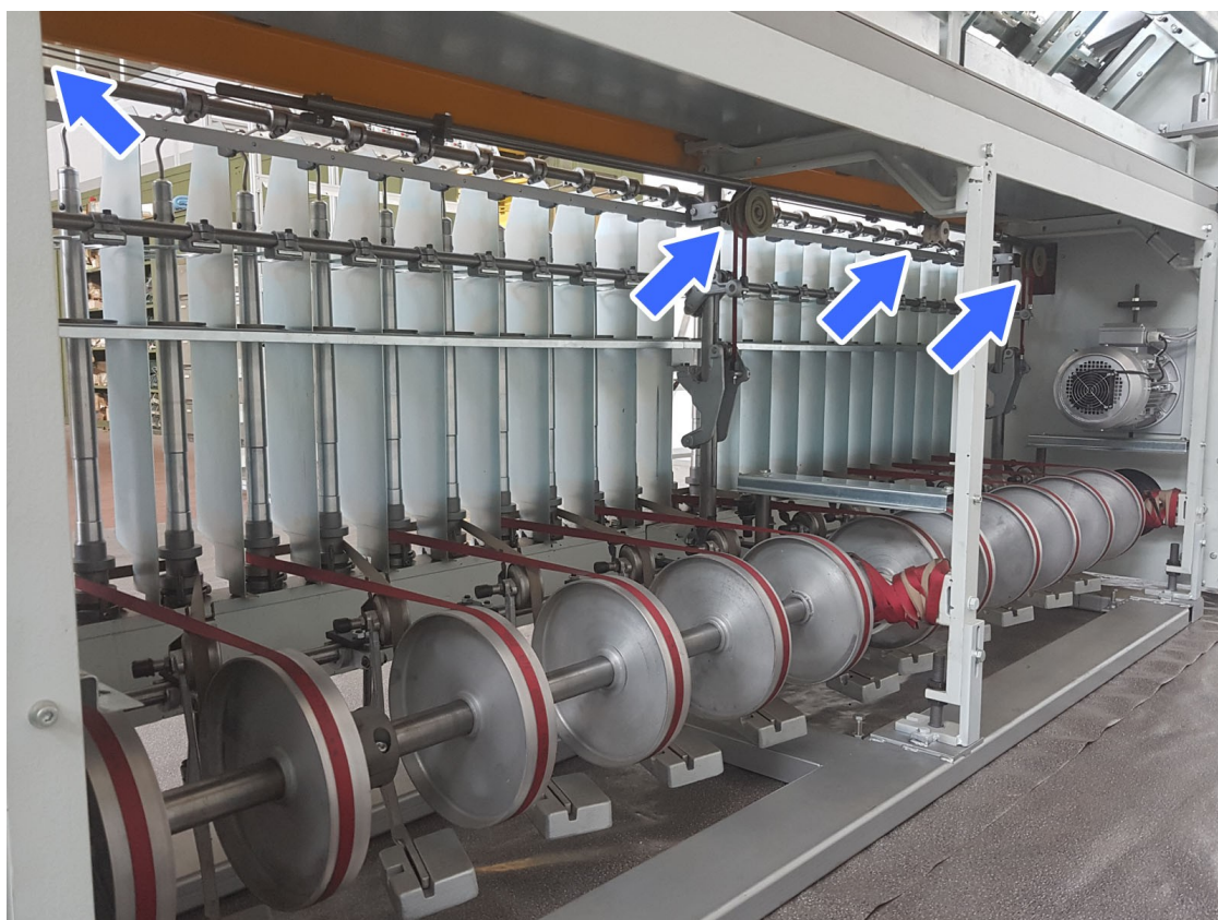
Figura 4.4.3 – Verifica delle cinghie di comando del banco fusi
