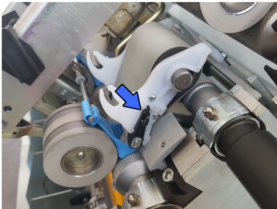
Figura 6.1.4 – Regolazione del nastro di controllo
