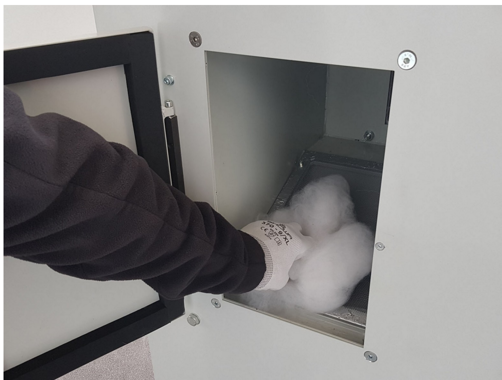
Figura 5.5.9 – Rimozione delle fibre aspirate
