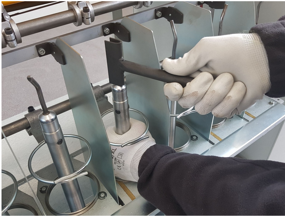
Figura 6.1.5 – Rimozione della testa filante
