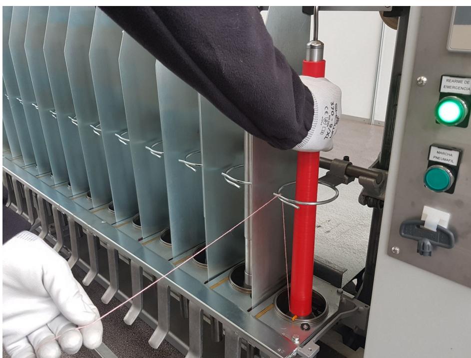
Figura 5.5.13 – Inserimento del tubetto nel fuso
