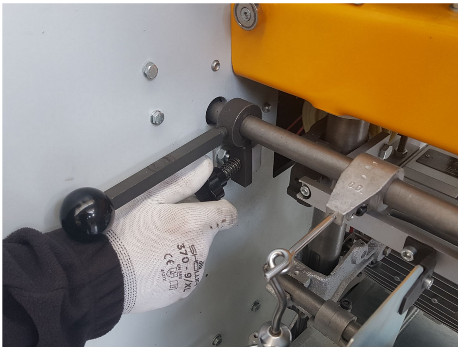
Figura 6.1.6 – Regolazione di precisione della tensione del filo
