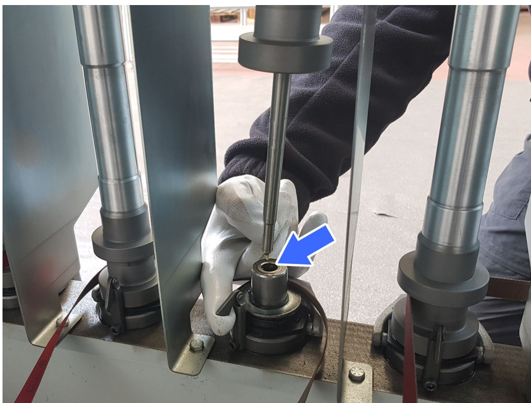
Figura 6.4.6 – Lubrificazione del cuscinetto a sfere alla base del fuso
