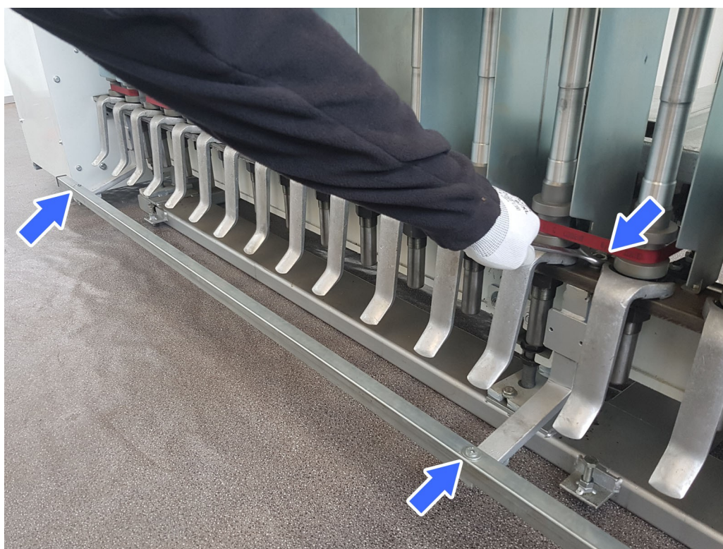
Figura 4.4.15- Posizionamento della barra di sostegno per la frenatura
