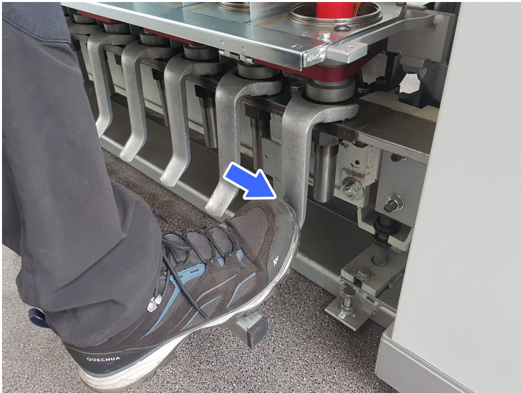
Figura 5.5.17 – Attivazione del freno del fuso
