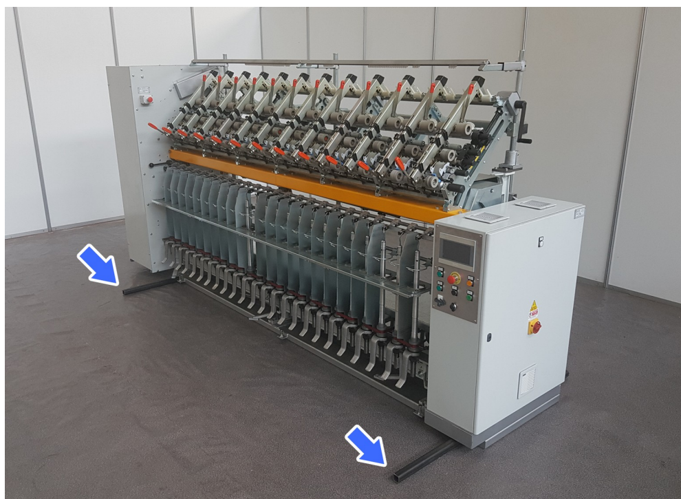
Figura 3.3.2 – Passaggi inferiori per le barre di appoggio
