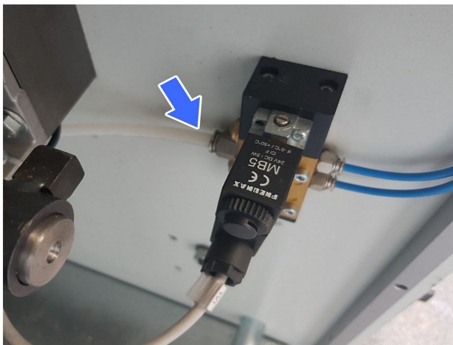
Figura 4.4.17 – Collegamento della Macchina all'impianto dell'aria compressa
