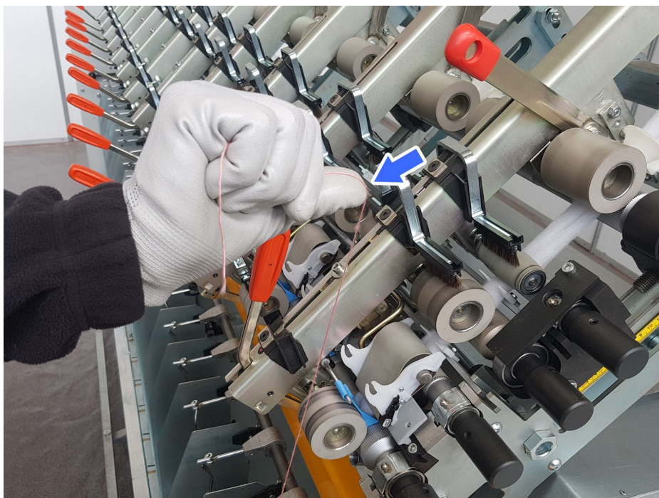
Figura 5.5.19 – Posizione delle dita per l'avvicinamento al rullo
