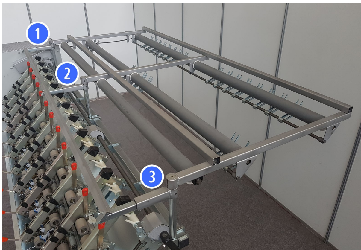
Figura 4.4.10 – Posizionamento della rastrelliera di alimentazione
