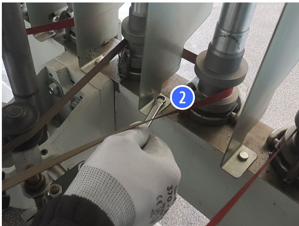
Figura 4.4.5 – Rimozione delle lamiera divisoria
