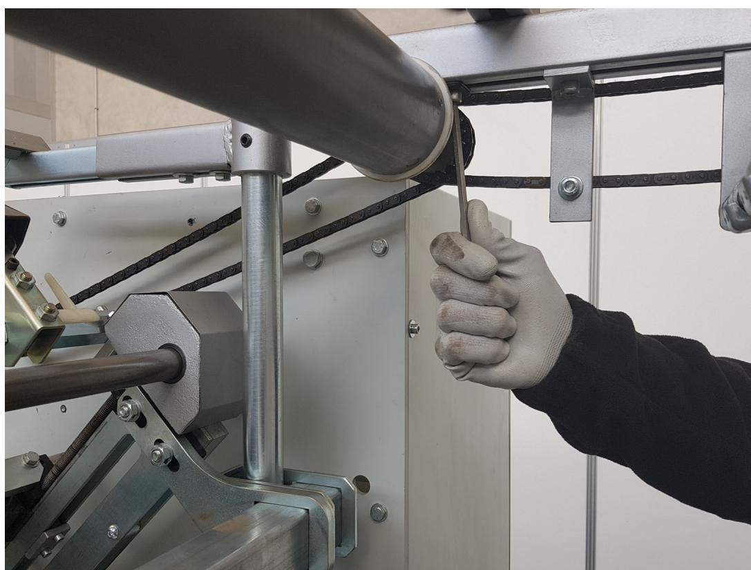
Figura 4.4.11 – Collegamento delle catene di comando della della rastrelliera di alimentazione
