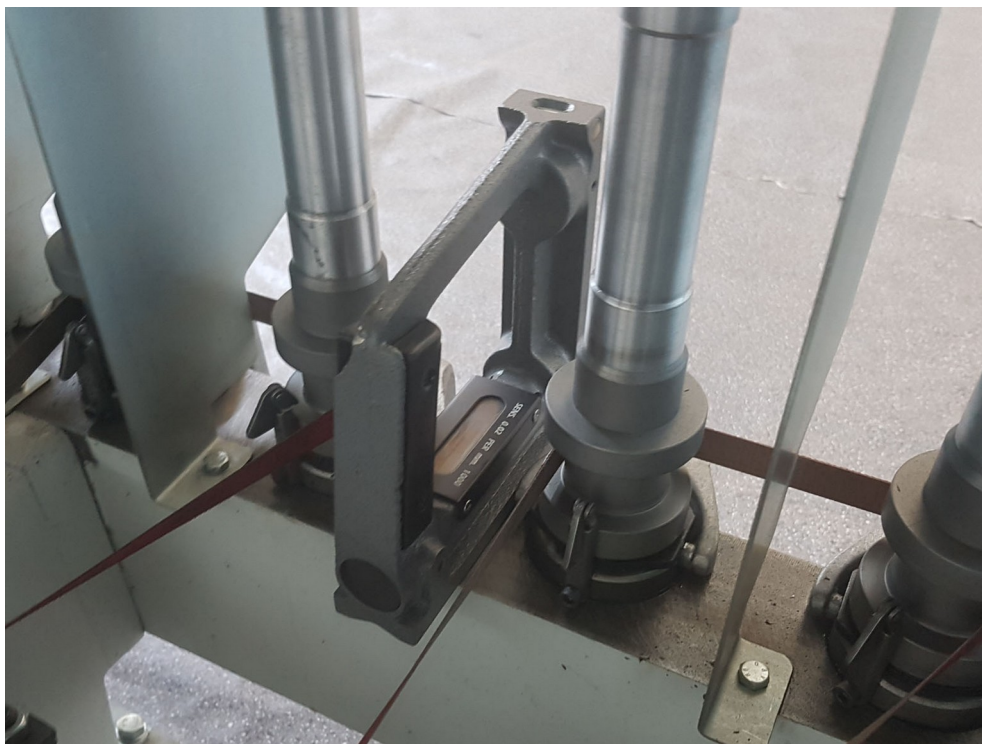
Figura 4.4.7 – Posizionamento della livella
