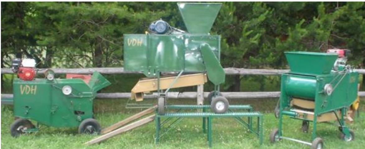
Figura 4: Equipo de despalillado y clasificación de orégano con motor eléctrico de 5 HP. Rendimiento de 80 kg de orégano limpio por hora. Marca VDH, Argentina. Disponible en: [http://www.vdhmaquinas.com.ar/index.php?option=com\\_content&view=article&id=14&Itemid=12](http://www.vdhmaquinas.com.ar/index.php?option=com_content&view=article&id=14&Itemid=12)
