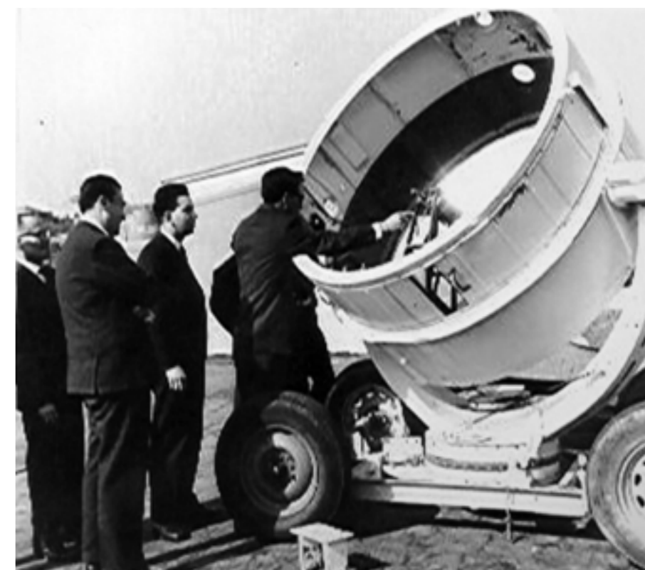
HORNO SOLAR DURANTE PRUEBAS DE INSPECCIÓN. LABORATORIO SOLAR DE LA UTFSM.
