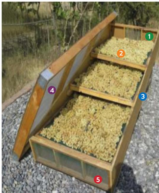
1. **Sección Salida:** Similar a la sección de entrada, pero con los 2/3 de su tamaño cubierto y solo 1/3 con salida cubierta con malla mosquitero.
