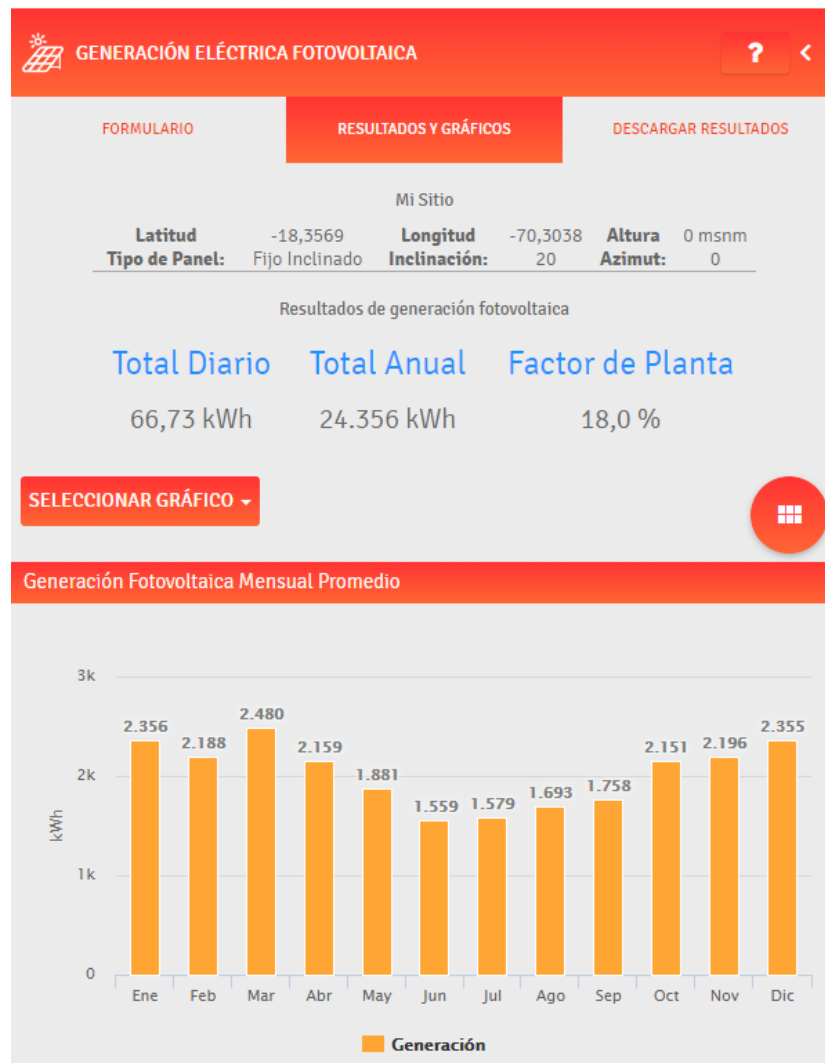
Figura 7: Simulación de sistema solar fotovoltaico (elaboración propia en explorador solar de la Universidad de Chile)
