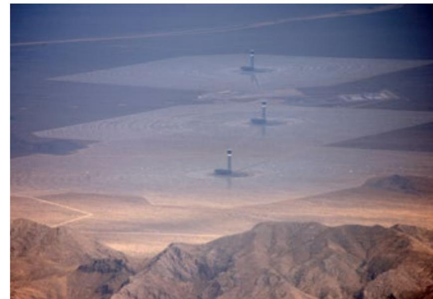
**IVANPAH:** En el desierto de Mojave, en California, opera desde 2014 la planta de energía solar térmica concentrada más grande del mundo. Es considerada un hito debido a sus 1.300 hectáreas y su capacidad para generar 400 MW, suficientes para abastecer a 140 mil hogares. El sistema redirige la radiación desde sus 300 mil espejos hacia una torre central, donde se produce el vapor que hace girar una turbina.
